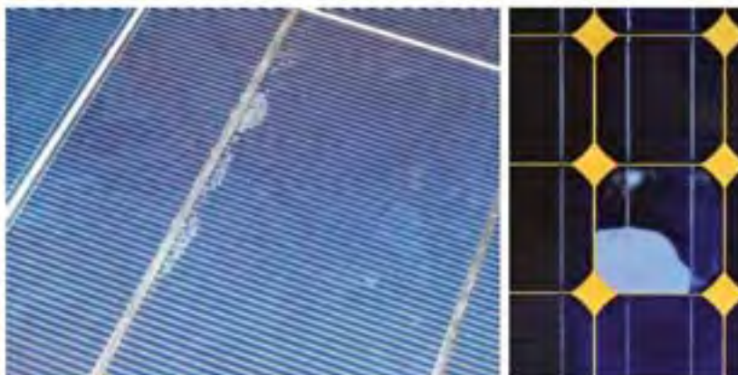
Fig. 25 Deslaminación en barra colectora del panel.
