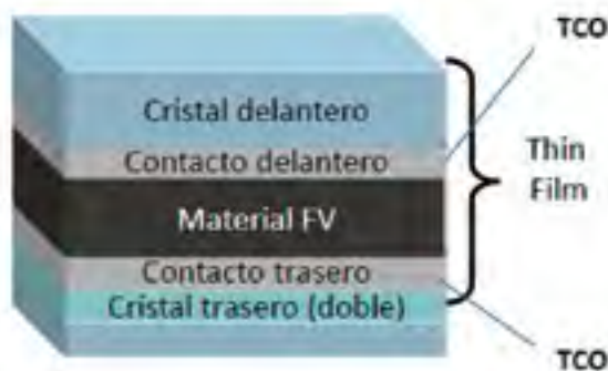
Fig. 5 Estructura y componentes de un panel fotovoltaico.
