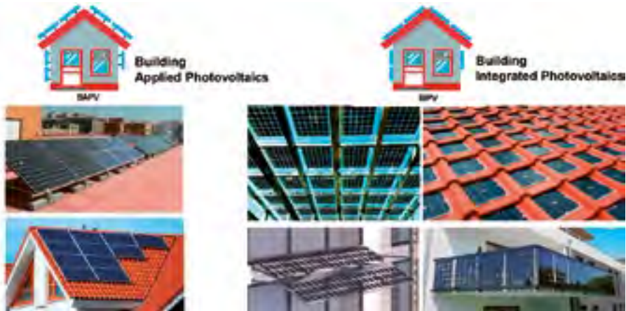
Fig. 27 Esquema de BAPV y BIPV.
